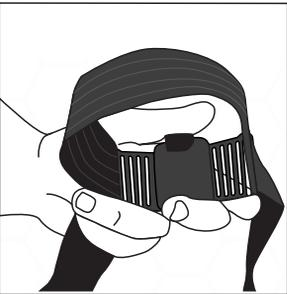
1. Conecta el adaptador para el torso al cinturón de la pelvis. Coloca el adaptador para que el cinturón pase sobre la parte superior de la cuna del sensor MyoMotion™.
