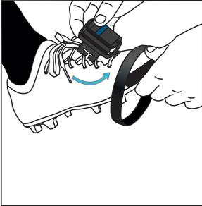
1. Coloca el sensor MyoMotion™ en la cuna del adaptador para calzado. Desliza el gancho del adaptador para calzado debajo del primer cordón del zapato.
