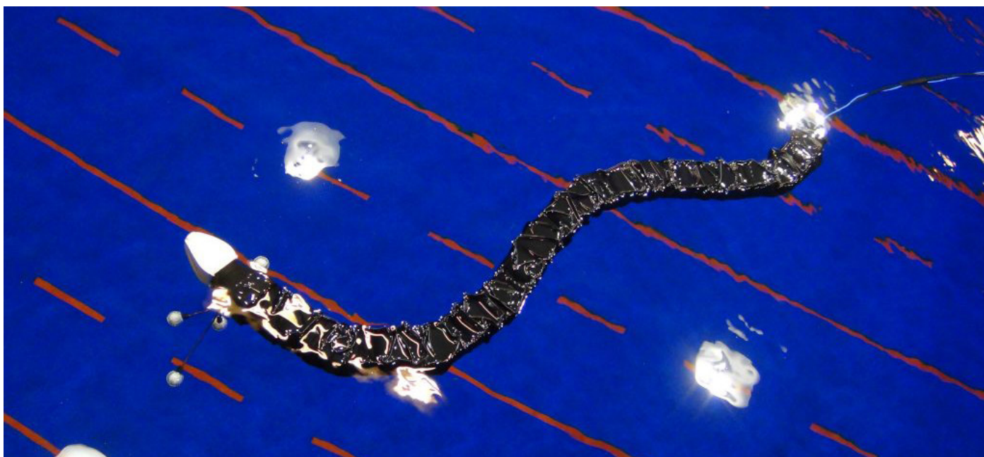
Un sistema de cámaras submarinas de Qualisys es capaz de capturar el movimiento de un robot serpiente en NTNU AMOS para análisis de control de trayectoria.
