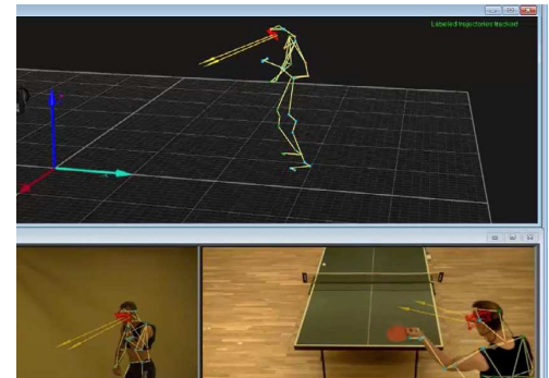
Capture y visualice datos de eye tracking en QTM, obteniendo el vector de la mirada junto al del movimiento corporal.
